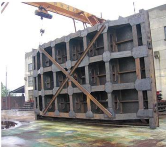
SLZ型钢闸门（制作现场）
